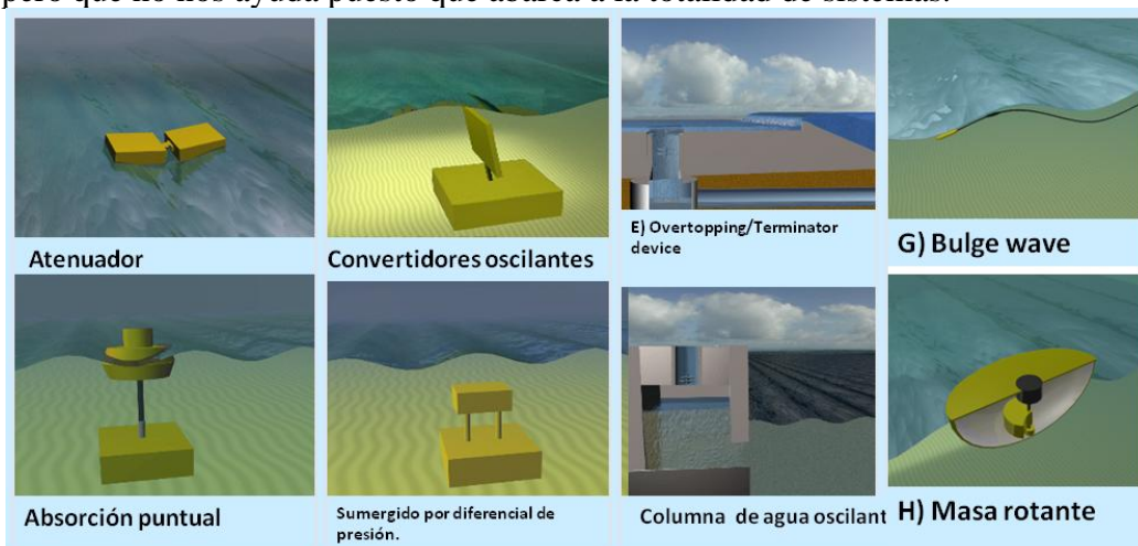
Imagen 25: Clasificación de convertidores de olas según el principio de captación.
