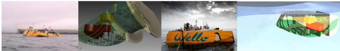
Imagen 78 : Disposición interna e imágenes exteriores del sistema Wello Oy.
