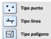
Figura 4. Tipos de geometrías básicas en Arcgis
