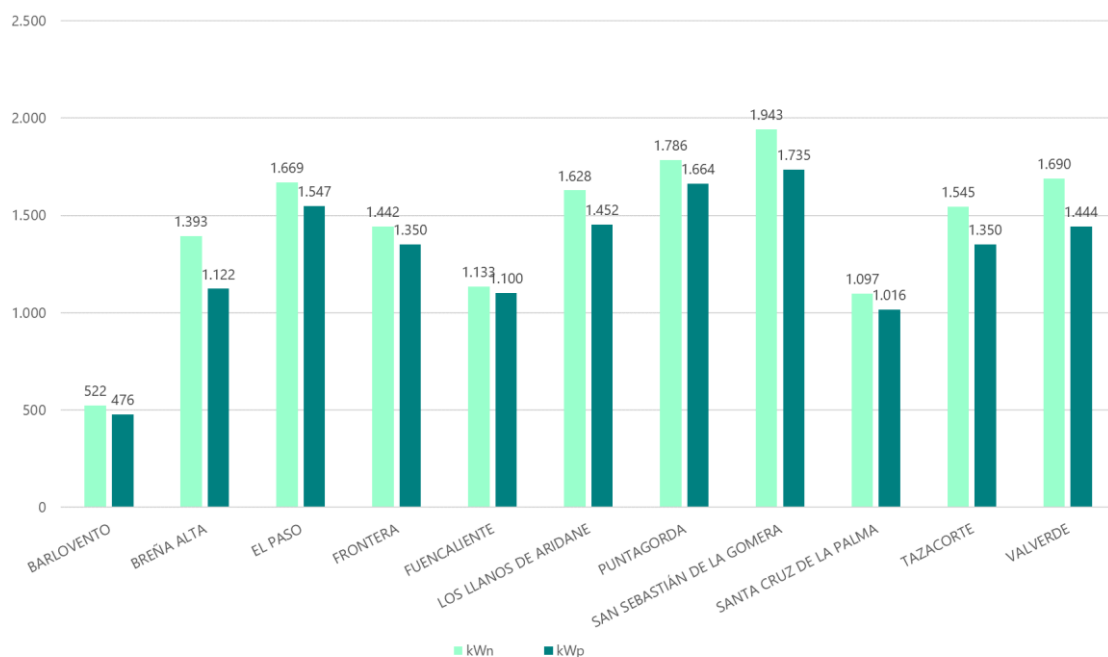
Gráfico 78. Comparativa de horas equivalentes de las instalaciones fotovoltaicas que vierten a la red eléctrica al menos un mes al año, por municipios, en La Palma, La Gomera y El Hierro. Año 2019.
