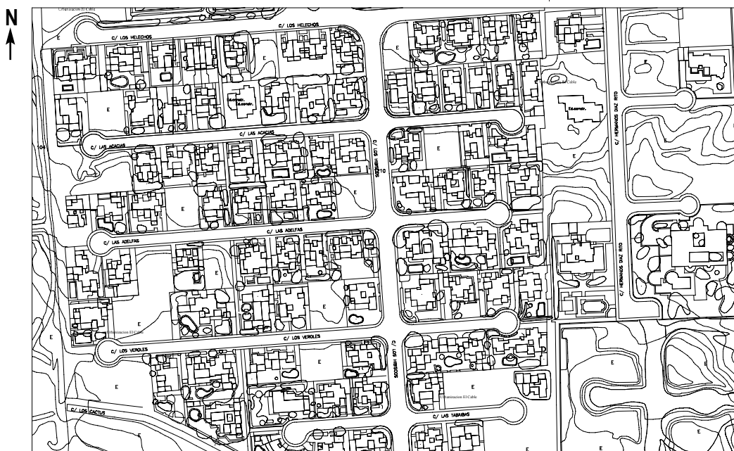
Figura 7. Modelo de trama con la que se consigue que una de las dos fachadas principales estén orientadas a sur y sean pasantes (urbanización El Cable, Arrecife)
