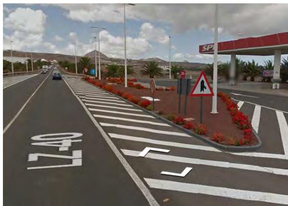
Ilustración 30: Señales P-1c y R-400c en P.K.s 0+790 y 0+760 respectivamente (descendente). Fuente: IDECanarias
